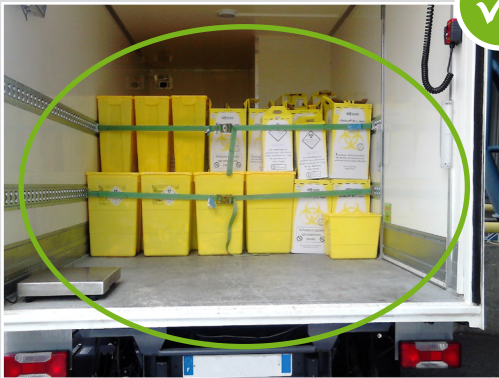
Caisson solidaire du véhicule, réservé aux déchets et doté d'un plancher lavable
