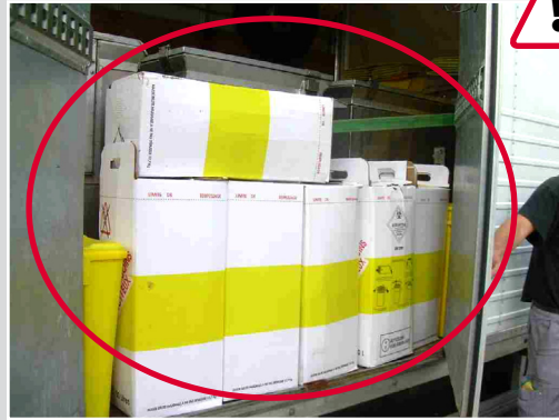
Caisson solidaire non conforme (véhicule non adapté, car équipé d'un plancher en bois, donc non lavable)
